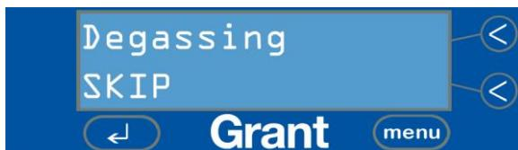
La procédure de dégazage consiste à retirer toutes les bulles de l'eau, ces bulles pouvant entraver l'exécution du nettoyage. Une fois l'ensemble des bulles arrivé à la surface, l'utilisateur peut terminer le cycle de dégazage en appuyant sur la touche ↲.
