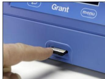
Durch Speichern der Parameter auf einer MC-Karte und Übertragen an einen PC können Reinigungsprogrammparameter dauerhaft gespeichert werden.
