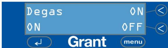
Die gewünschte Option kann mit den Tasten 3 und 4 ein- bzw. ausgeschaltet werden. Eine Erläuterung der Notwendigkeit einer Entgasung finden Sie auf Seite 25.
