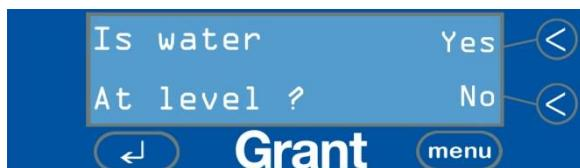
Cuando se desactiva el sensor de nivel, la temperatura del líquido establecida se reduce automáticamente a 5 °C. La temperatura establecida se puede aumentar en el sistema de MENÚ (consulte la página 9).
