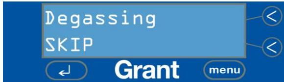
Mit dem Entgasungsprozess können Luftblasen aus dem Wasser entfernt werden, da diese die Reinigungsleistung beeinträchtigen. Wenn alle Luftblasen an der Oberfläche sind, kann der Entgasungsprozess durch Drücken der Taste < beendet werden.
