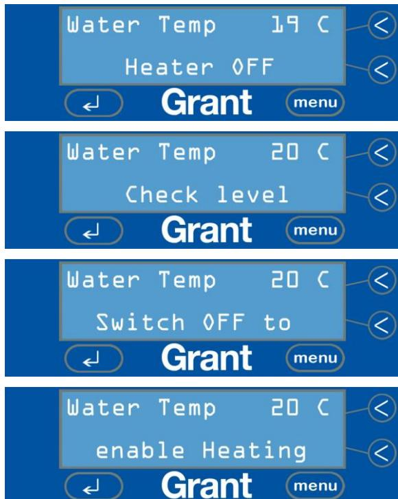
Para continuar utilizando el baño de ultrasonido digital de Grant, rellene con líquido hasta el sensor de nivel de líquido, y apague y vuelva a encender la unidad.
