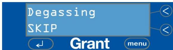
El proceso de desgasificación consiste en eliminar todas las burbujas del agua ya que estas impiden que se pueda efectuar la limpieza. Una vez que todas las burbujas han llegado a la superficie, complete el ciclo de desgasificación al pulsar la tecla  $\leftarrow$ .
