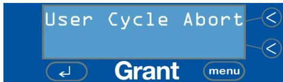
Si le capteur de niveau est activé, et que le niveau du liquide descend en dessous du niveau requis pour le fonctionnement, le cycle de nettoyage s'arrête et l'écran suivant apparaît.
