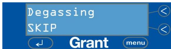
Il processo di degassazione rimuove tutte le bolle dall'acqua, che riducono l'efficienza della pulizia. Quando tutte le bolle sono salite in superficie, completare il ciclo di degassazione premendo il tasto  $\leftarrow$ .
