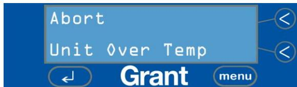
In diesen Programmabbruchsfällen wird das Programm trotzdem als abgeschlossen interpretiert und der Programmlaufzähler im Menü ADVANCED inkrementiert.
