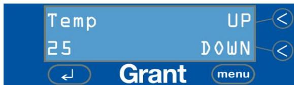
Utilice las teclas ARRIBA y ABAJO para ajustar con precisión la temperatura del líquido de limpieza entre ambientale y 70 °C.
