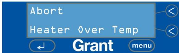
Wenn sich das Gerät aufgrund von zu langem Gebrauch überhitzt, wird die folgende Mitteilung angezeigt.
