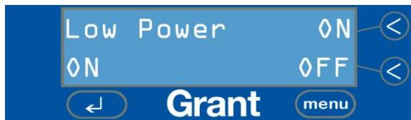
Si se activa el ahorro de energía, a los cinco minutos de inactividad el baño entra en modo de espera (SLEEP): la iluminación del visor se atenúa y el calentador de agua interno deja de funcionar.
