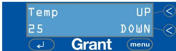
Die gewünschte Temperatur der Reinigungsflüssigkeit kann mit Taste 3 und 4 im Bereich von umgebungstemperatur und 70°C eingestellt werden.
