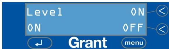
Il sensore di livello è uno strumento resistivo che non è in grado di rilevare i liquidi con bassissimo livello di conduttività, come l'acqua deionizzata pura (DI), e che quindi può essere disabilitato per le applicazioni specifiche di lavaggio che richiedono l'uso di acqua deionizzata.
