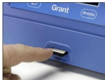
Registrando i parametri del ciclo di lavaggio sulla scheda MC e trasferendoli ad un PC è possibile ottenere una registrazione elettronica permanente di tali parametri.
