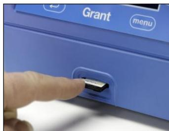
Si guarda la información en una tarjeta MC y la transfiere a un ordenador, podrá mantener un registro electrónico permanente de los parámetros de los ciclos de limpieza.
