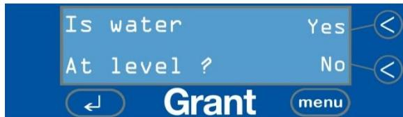
Wenn der Füllstandssensor deaktiviert ist, wird die eingestellte Temperatur der Flüssigkeit automatisch auf 5 °C reduziert. Die eingestellte Temperatur kann im MENÜ-System erhöht werden (siehe Seite 9).
