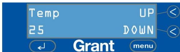
Utilizzare i tasti UP (Su) e DOWN (Giù) per impostare con precisione la temperatura del liquido di lavaggio tra ambiente e 70 °C.
