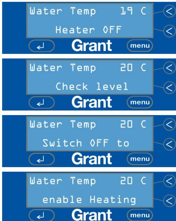
Um das digitale Ultraschallbad von Grant weiterhin zu verwenden, muss die Flüssigkeit bis zum Flüssigkeitsfüllstandsensor aufgefüllt und das Gerät aus- und wieder eingeschaltet werden.
