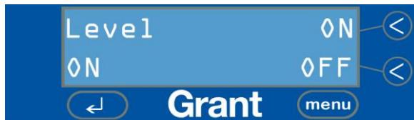
Le capteur de niveau est un dispositif résistif, par conséquent il ne détectera pas les liquides ayant une très faible conductivité tels que l'eau déionisée pure. Le capteur de niveau peut être désactivé pour des applications de nettoyage spécifiques qui utilisent de l'eau déionisée.
