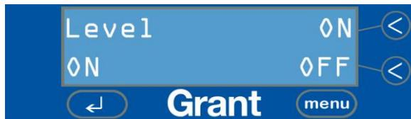
Der Füllstandssensor arbeitet nach dem Widerstandsprinzip, das heißt, er kann Flüssigkeiten mit sehr geringer elektrischer Leitfähigkeit wie reines entionisiertes Wasser nicht erkennen. Für Spezialanwendungen, bei denen entionisiertes Wasser zum Einsatz kommt, kann der Füllstandssensor deaktiviert werden.
