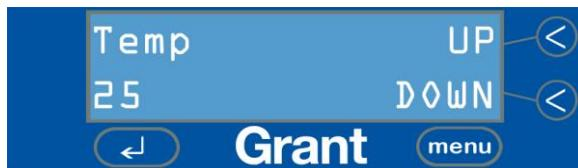
Les touches UP (Haut) et DOWN (Bas) permettent de régler avec précision la température voulue du liquide de nettoyage, comprise entre ambiante et 70 °C.
