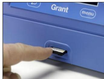
Grâce à l'enregistrement des paramètres sur une carte MC et leur transfert sur un ordinateur, un enregistrement électronique permanent des paramètres de cycle de nettoyage est sauvegardé.
