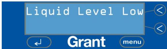
Für spezielle Reinigungsanwendungen, bei denen de-ionisiertes Wasser verwendet wird (siehe Seite 18), kann der Füllstandssensor deaktiviert werden.
