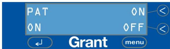
Beim Drücken auf ON werden Heizung und Ultraschallgenerator unabhängig von den Programmeinstellungen eingeschaltet.
