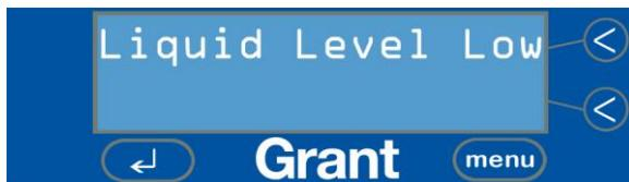
Le capteur de niveau peut être désactivé pour les applications de nettoyage spécialisées lors d'une utilisation avec de l'eau déminéralisée (voir page 18).
