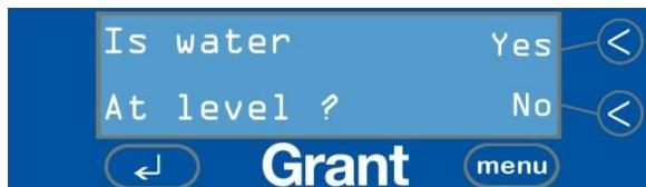
Lorsque le détecteur de niveau est désactivé, la température préréglée du liquide est automatiquement diminuée de 5°C. La température préréglée peut être augmentée via le MENU (voir page 9).
