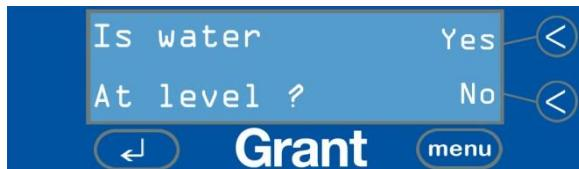
Quando il sensore di livello è disattivato, la temperatura impostata per il liquido viene automaticamente ridotta a 5 °C. La temperatura impostata può essere aumentata entrando nel sistema MENU (v. pag. 9).
